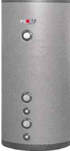
Acumulador de inercia SPU-1-200 fabricado en acero S37-JR (St 37-2). Revestimiento de lámina en color plata Wolf, sin protección anticorrosiva de la pared interior del depósito, porque está destinado exclusivamente al uso como acumulador de inercia para agua de servicio en instalaciones de calefacción cerradas.
